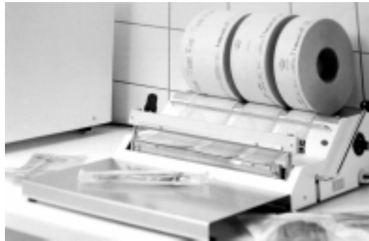
Figura 15. Termoselladora manual de bolsas de esterilización
