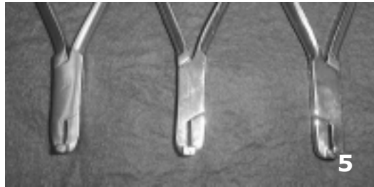
Figura 5. Alicates para conseguir dobleces de \frac{1}{2} , \frac{3}{4} , y 1 mm con sólo pinzar el alambre. Los alicates tienen 2 puntas para realizar dobleces en ambos sentidos. Vista de las puntas activas de los alicates (Izda. centro)
