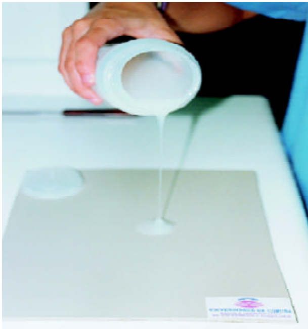
Figura 4. Polímero de silicona, para ortosis en forma fluida de color translúcido y baja viscosidad.
