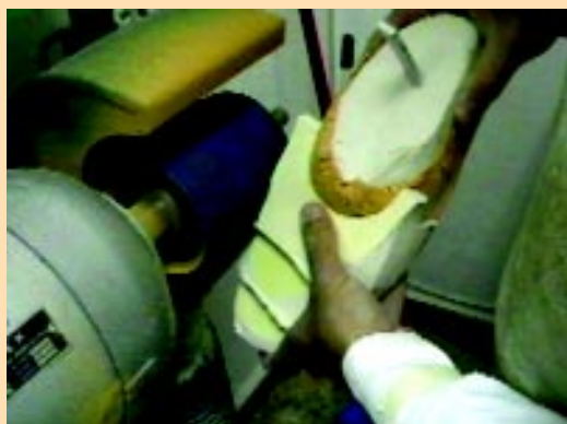
Figura 9. Desbastado de relleno de antepie
