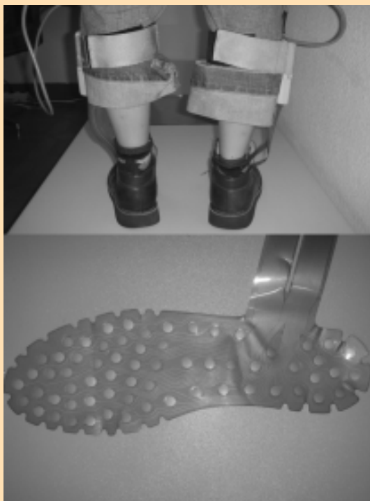
Figura 1. Sistema Biofoot®. Plantilla con 64 sensores piezoeléctricos.
